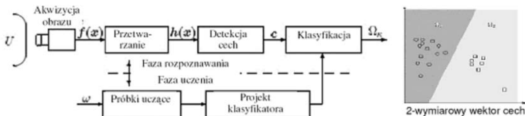
Rys. 2.2. Schemat klasyfikacji prostych wzorców
