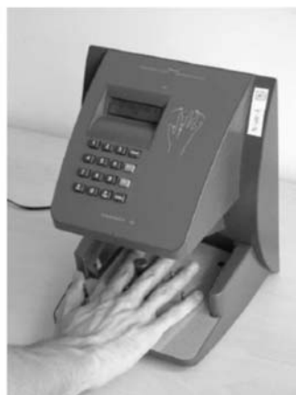
Rys. 3.4. Przykłady urządzeń (Hanarunch 1000 [www.timeclockplus.com] i HandKey I [16] firmy Recogniton Systems Inc.) do ściśle określonych warunków pomiaru dłoni
