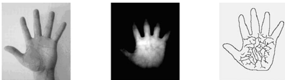
(a) obraz z kamery mono (b) obraz termowizyjny (c) naczynia krwionośne
