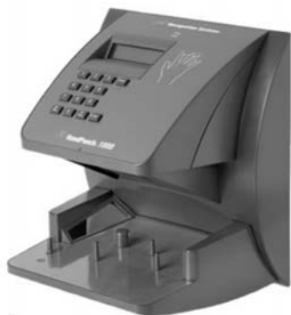
Rys. 3.4. Przykłady urządzeń (Hanarunch 1000 [www.timeclockplus.com] i HandKey I [16] firmy Recogniton Systems Inc.) do ściśle określonych warunków pomiaru dłoni
