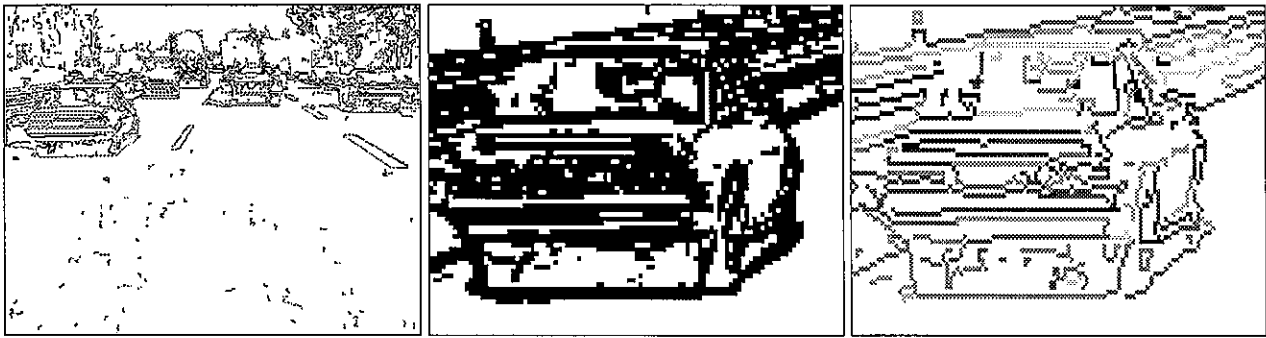
Bild 3.2.1: Die detektierten Liniensegmente (links) und Vergleich zwischen Kantenelementen im Kantenbild (mitte) und Liniensegmenten (rechts) am Beispiel eines PKWs.
