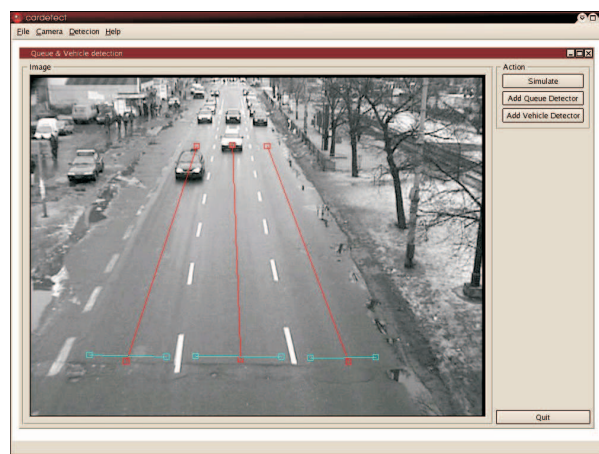
Rysunek 6. Linie poziome wyznaczają bramki, w których zliczana jest liczba pojazdów. Linie pionowe reprezentują pasy ruchu, wzdłuż których mierzona jest długość kolejki.
