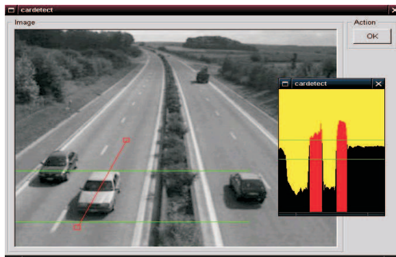
Rysunek 6. Linie poziome wyznaczają bramki, w których zliczana jest liczba pojazdów. Linie pionowe reprezentują pasy ruchu, wzdłuż których mierzona jest długość kolejki.
