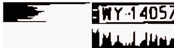
Rysunek 13. Analiza 2 histogramów - wzdłuż osi X i Y - w celu detekcji pojedynczych znaków.
