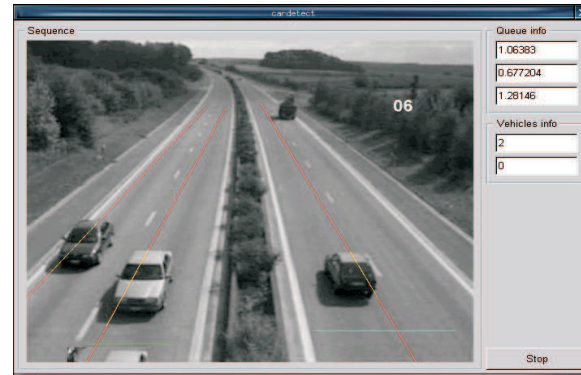
Rysunek 6. Linie poziome wyznaczają bramki, w których zliczana jest liczba pojazdów. Linie pionowe reprezentują pasy ruchu, wzdłuż których mierzona jest długość kolejki.
