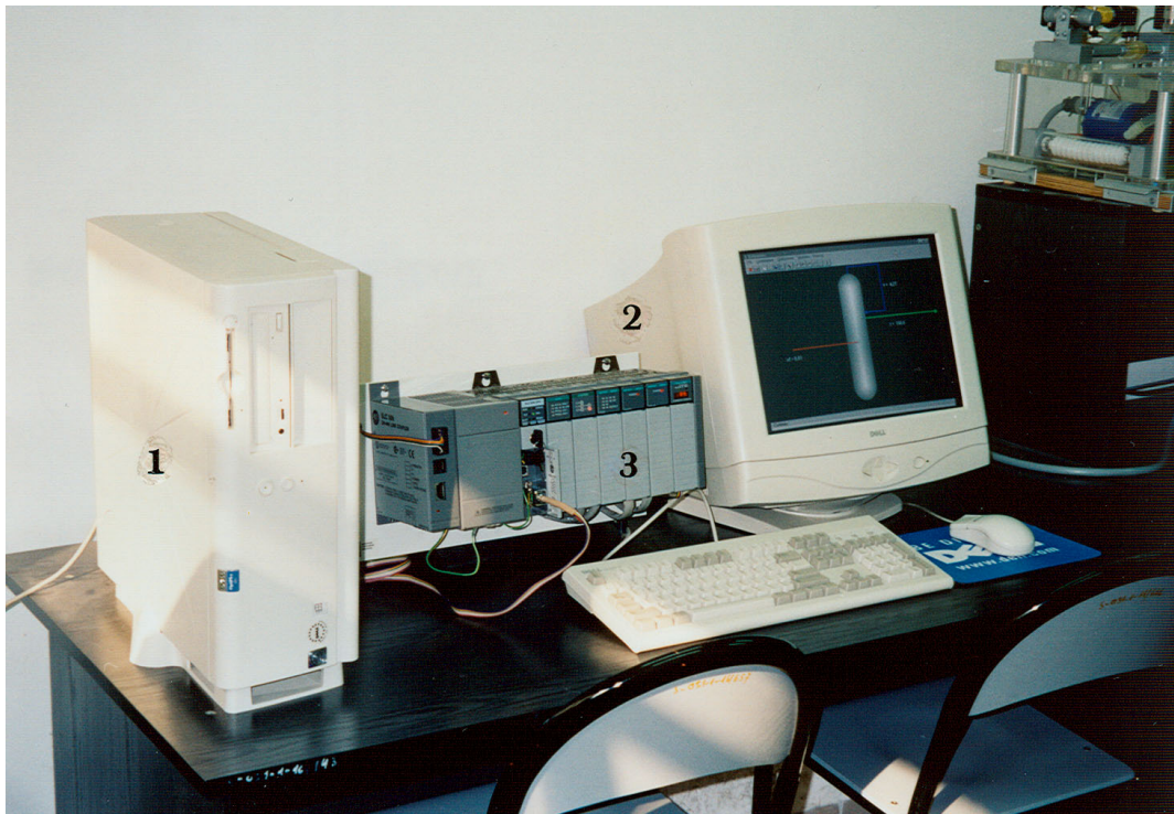
Rys. 6.2. Wygląd stanowiska laboratoryjnego: 1 – komputer PC, 2 – monitor, 3 – sterownik PLC
