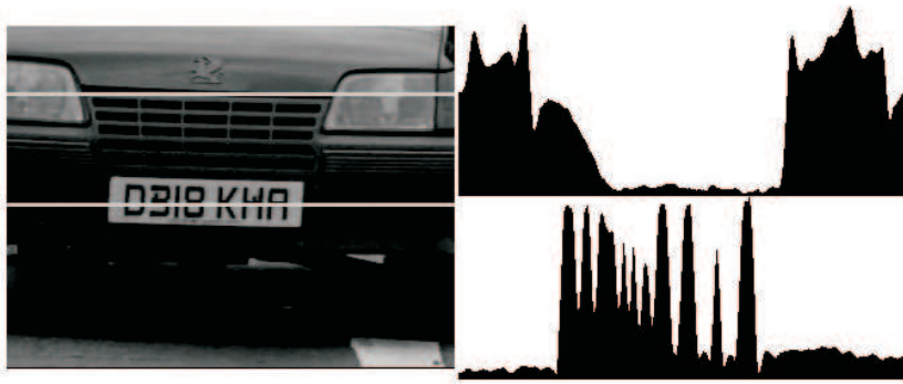
Rys. 10: Idea etapu detekcji obszaru tablicy – analiza rozkładów jasności wzdłuż linii obrazu
