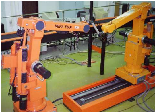
Rys. 8: Dwa roboty IRp-6 przenoszące wspólnie sztywną belkę
