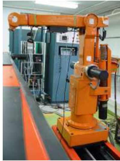
Rys. 3: Robot IRp-6 na torze jezdny
