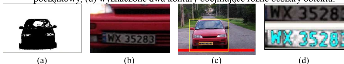
Rys. 1.14. Przykład segmentacji obrazu - wyznaczenie tablicy rejestracyjnej: (a) detekcja ruchomego obiektu, (b) określenie obszaru zainteresowania, (c) wyznaczenie obszaru tablicy rejestracyjnej, (d) wyznaczenie pojedynczych znaków.
